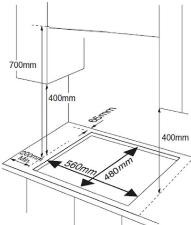
Potrebne udaljenosti pri ugradnji ploče ispod kuhinjske nape
