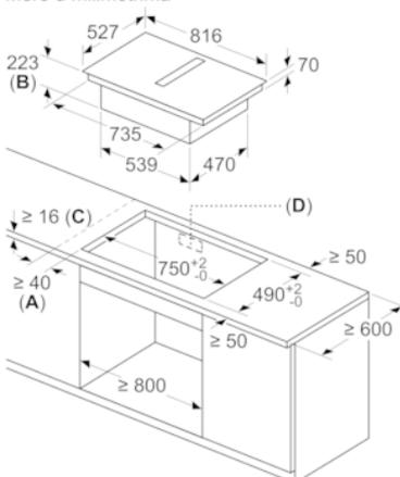
A: Najmanje rastojanje od isečka ploče za kuvanje do zida
