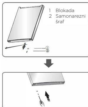
9.Premestite poklopce (odnosno čepiće) otvora za šrafove na čeonoj stranici pregradnog zida između rashladnog i zamrzivačkog dela aparata sa leve na desnu stranu (kao što to prikazuje donja slika).
