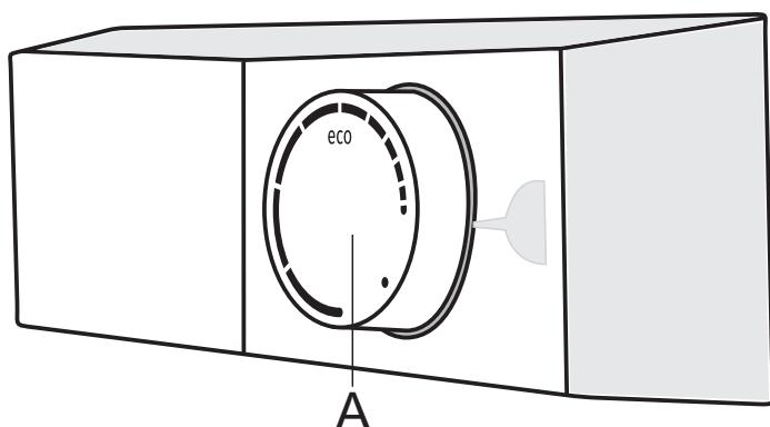
**A dugme za regulisanje temperature – uključenje/isključenje aparata**
