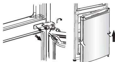
8.Gornja vrata stavite na glatku podlogu tako da ploča vrata bude okrenuta nagore. Otpustite šraf (2) i deo (1), a zatim ih premestite na levu stranu i tamo učvrstite.
