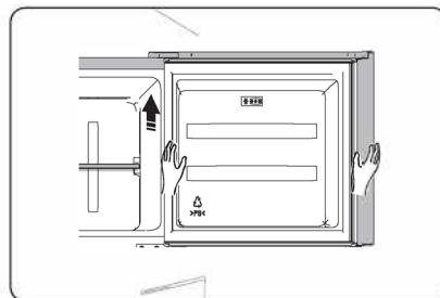
6. Gornja vrata stavite na glatku podlogu tako da ploča vrata bude okrenuta nagore. Otpustite šraf (2) i deo (1), a zatim ih premestite na levu stranu i tamo učvrstite.
