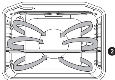
Deluju okrugao grejač i ventilator. Ventilator na zadnjoj stenki peći brine za stalno kruženje vrućega vazduha oko pečenja ili kolača.
