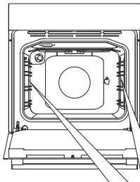
Odstranite žičane odnosno teleskopske vodilice.
