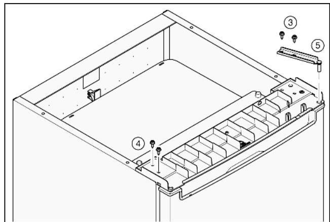
7. Skinite vrata uređaja i odložite ih na mekanu podlogu.
