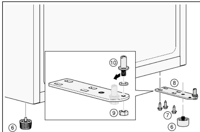
13. Utaknite svornjak (10) u levi otvor i postavite i pritegnite navrtku (9).
