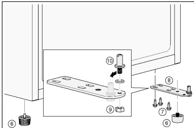
13. Utaknite svornjak (10) u lijevu rupu i stavite maticu (9) i pritegnite.
