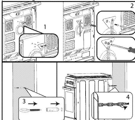
**i** Stabilizacioni lanac treba da bude što je moguće kraći da bi se sprečilo da se rerna naginje prema napred i treba da stoji dijagonalno da bi se sprečilo bočno naginjanje renera.
