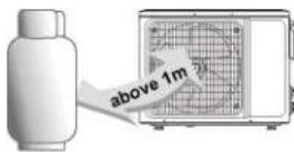
Nemojte instalirati klima uređaj na mesto gde postoji zapaljivi gas ili tečnost. Udaljenost između njih mora biti više od 1m. Ovim možete uzrokovati požar ili čak i eksploziju.
